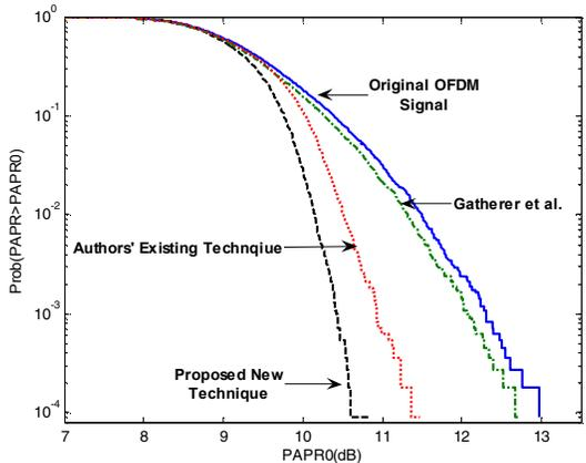
Fig. 3: CCDF plots of a 16QAM 802.16e WiMAX signal.
